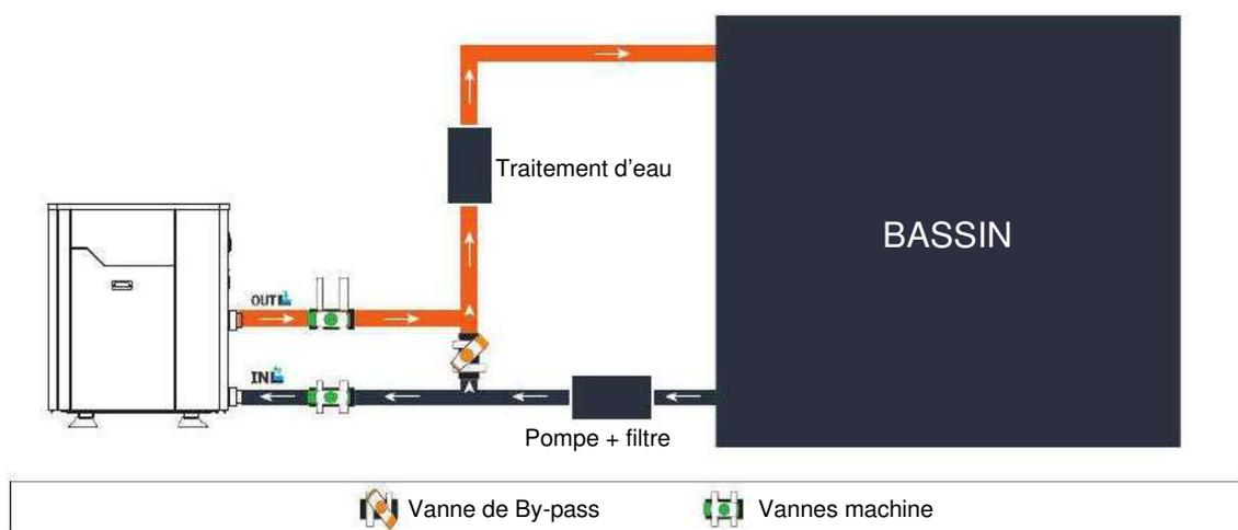
Si votre installation est équipée avec un traitement avec adduction de produits (chlore, brome, sel, ...) le by-pass doit être installé avant le traitement de l'eau avec un clapet anti-retour entre le by-pass et le traitement d'eau.
